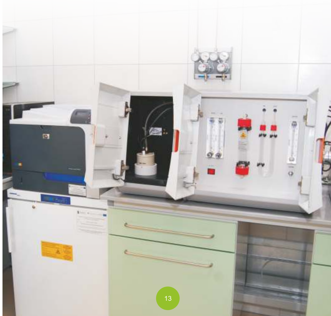
Automatyczny analizator Multi EA 4000 niemieckiej firmy Analytik Jena do oznaczania zawartości chloru za pomocą analizy kulometrycznej
