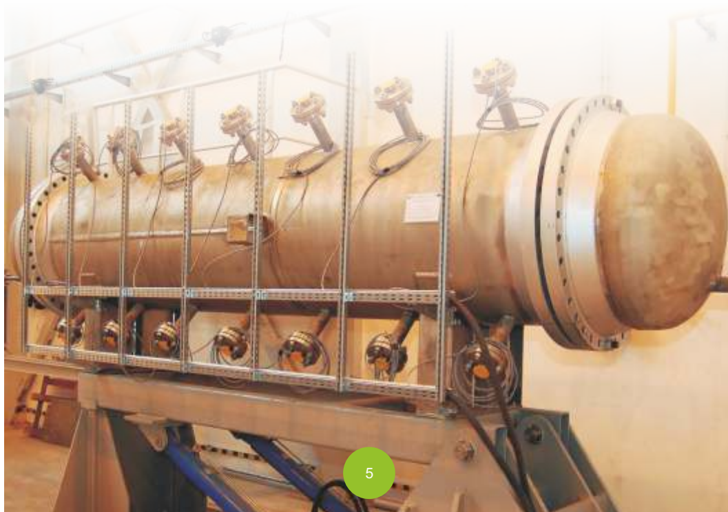
Instalacja do ciśnieniowej symulacji procesu podziemnego zgazowania węgla
