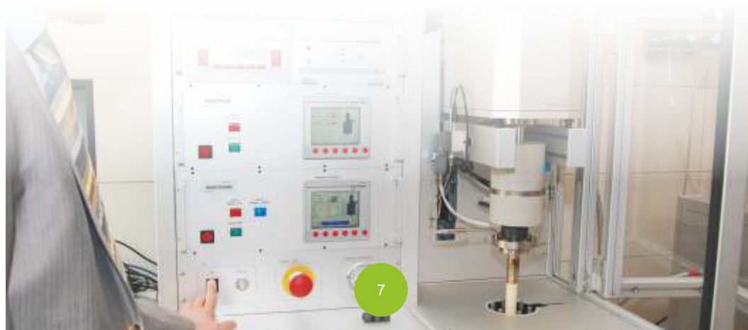
Wysokociśnieniowy analizator termogravimetryczny z kwadrupolowym spektrometrem masowym
