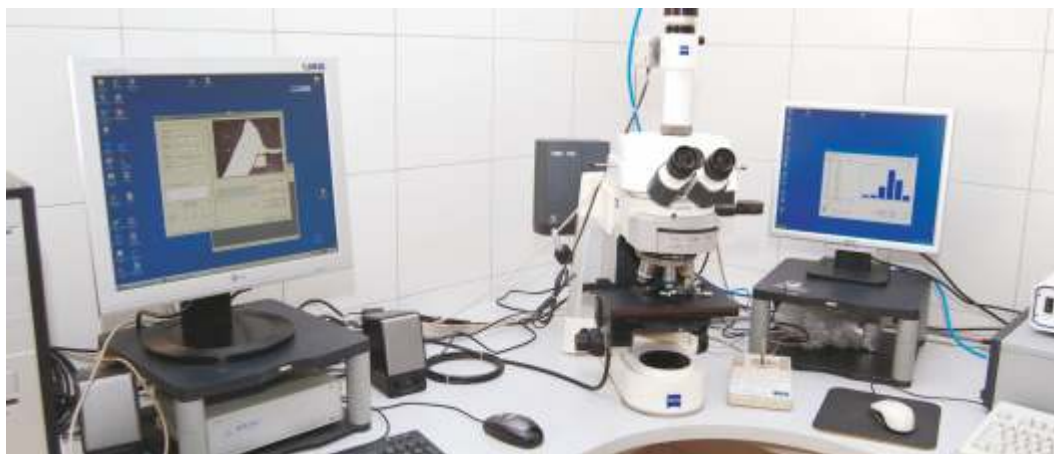
Mikroskop AXIO do oznaczania zdolności odbicia światła wityrytu i składu grup macerałów
